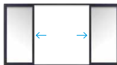
4 VANTAUX 2 RAILS largeur jusqu'à 5,80 m
